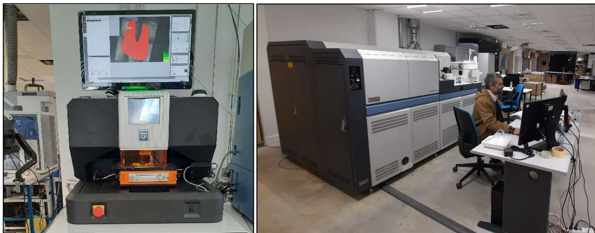
Foto 13 și 14. Inceputul lucrului pe sistemul Excimer de ablație laser (stânga). Primele încercări de analize cu Neptune Plus (dreapta)
