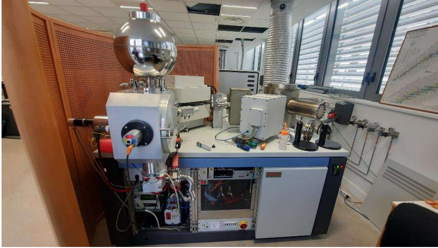
Foto 15. Spectrometrul de masă cu Ionizare Termică (TIMS, Triton Plus)
