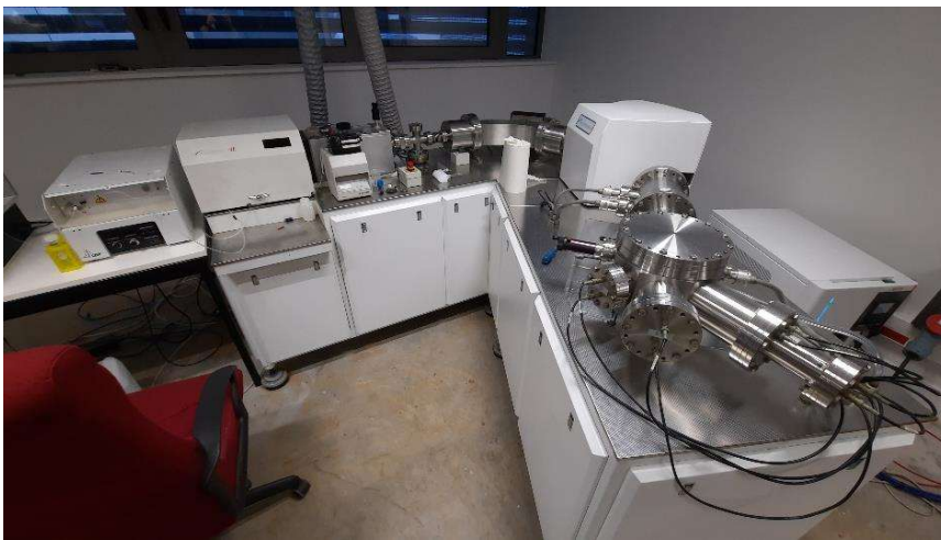
Foto 16. Un spectrometru de masă, de generație mai veche, Nu 500 HR
